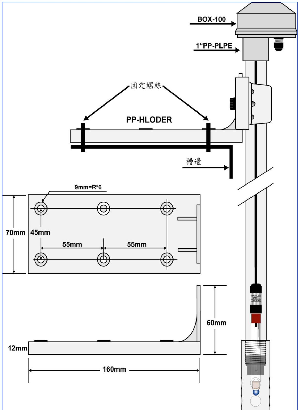
b: PP-5L 採樣杯+S12-E+PH 電極配置圖:
